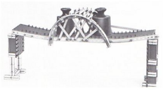
Abb. 199 Hier wird deutlich, daß die Bogenkonstruktion nur die von ihr überspannte Strecke versteift; auch die rechts hinten angebrachte Strebe (– Knickbelastung) ist nicht imstande, die Kräfte auf die Auflager zu übertragen: nur wenn der Bogen über den Auflagern „eingespannt“ wird, ist er imstande, die Last abzutragen.
