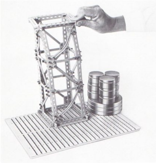
Abb. 321 Starker Druck („Winddruck“) auf eine Ecke läßt die Schüler deutlich erkennen, welche Streben auf Druck und welche auf Zug beansprucht sind. Die „ausgebeulten“ Streben sind druck- = knickbeansprucht, die gestrafften sind zugbeansprucht.
