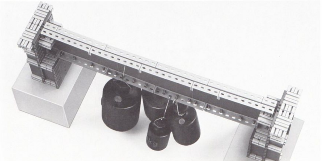
Abb. 135 Der Träger in Doppel-T-Form ist der geeignetste Biegeträger. Obergurt und Untergurt bringen den optimalen Stabilisierungseffekt oder (wie der Techniker sagt), die größte Biegesteifigkeit.
