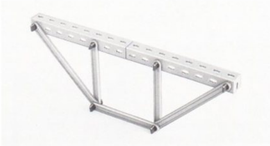
Abb. 156 Erst wenn der Obergurt in sich starr ausgebildet ist, kann das Fachwerk als starr bezeichnet werden.
