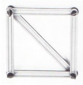
Abb. 150 Das Viereck der Abb. 147, 148 ist geöffnet worden: Im oberen linken und im unteren rechten Knotenpunkt sind jetzt S-Riegel 8 verwendet und eine X-Strebe 106 eingesetzt, die das Viereck in zwei rechtwinklige Dreiecke aufteilt und somit das kleine Fachwerk stabilisiert, d. h. stabil macht. – Anders ausgedrückt: Zwei zusammengesetzte rechtwinklige Dreiecke bilden ein starres Klein-Fachwerk.
