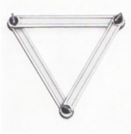
Abb. 149 Das Dreieck ist das kleinste in sich starre Fachwerk. – Der eine „weggelassene“ Stab erbringt absolute Stabilität auch bei gelenkiger Verbindung in den Knotenpunkten; Stabilität = Starrheit ist dann gegeben, wenn drei Stäbe in drei Knotenpunkten gelenkig verbunden sind; die Form des Dreiecks ist nicht entscheidend.
