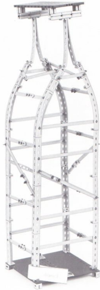
Abb. 329 Diese Lösung von Harald ist die wohl schwächste von allen. Dennoch ist es ein schönes Beispiel für „produktive Fehlleistungen“. Ein Abbau der bogenförmigen Endstücke wäre nicht unbedingt nötig, wenn eine Diagonalverstrebung in beiden Ebenen hinzukommt; diese muß unbedingt auch weiter unten mehrfach wiederholt werden. Die „Wipp-Plattform“, die dem Schüler zeitweise solchen „Spaß“ machte, mußte jedoch entfernt werden; er hatte eingesehen, daß diese „Spielerei“ dem Zweck, Last tragen zu können, nicht dienlich ist.
