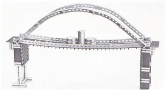
Abb. 200 Richtiges Anbringen der Bogenträger über den Auflagern bedeutet noch keine Stabilität der Fahrbahn. Es fehlt hier die Hauptsache: die „Verbindung“ zwischen tragendem Bogen und Fahrbahn in Form von Schnüren oder Streben.
