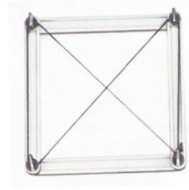
Abb. 153 Zwei Schnüre als Diagonalen im Viereck eingesetzt, ergeben auch eine Starrheit der Konstruktion, weil jetzt zwei Dreiecke gebildet werden. Die Schnüre sind jeweils Zugstreben.
