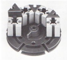
Abb. 65 In eine Drehscheibe eine Flachnabe fest eindrehen, dann 4 Bausteine 15 mit 2 schw. Zapfen in die Schlitzte schieben und mit 3 Winkelsteinen 60 Grad untereinander verbinden.
