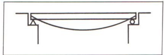
Abb. 55 Balken auf zwei Stützen
