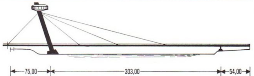
Bild 45 Donaubrücke Bratislava (1970), A-Pylon
