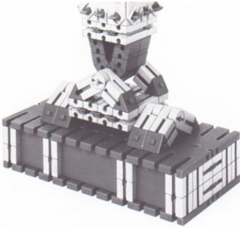
Abb. 311 Kardanische Lagerung für einen seilverspannten Mast mit verjüngter Aufrißform.
