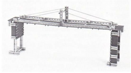
Abb. 195 Das Anbringen von Winkelträgern zu einem L-Profil auf den Fahrbahn-Platten erbringt gerade soviel Stabilität, daß die Konstruktion ihr Eigengewicht trägt. Die in der Mitte angebrachten Stützen werden durch die gespannten Seile jedoch nach unten gedrückt und biegen dadurch die Fahrbahn etwas durch; sie bewirken somit genau das Gegenteil dessen, was der Schüler beabsichtigte.
