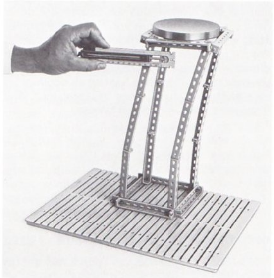
Abb. 317 Vier „richtige“ Eckstiele allein ergeben keine Festigkeit gegenüber seitlichen Kräften (Winddruck).
