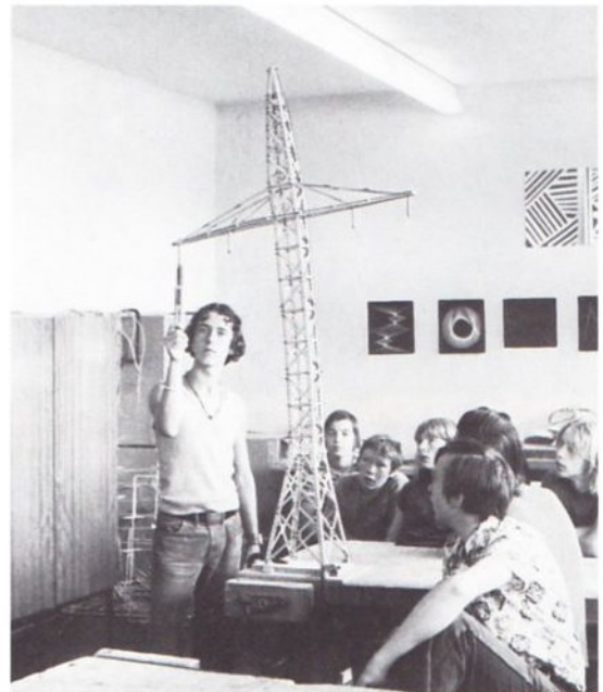
Abb. 299 Das in der Ergänzungsmappe B näher beschriebene Freileitungs-Mast-Modell wird einseitig belastet. Deutlich sind die Auswirkungen der Kräfte zu erkennen: Durchbiegung zur belasteten Seite hin = Druck in den Eckstielen (und in den „Fundamenten“) auf der Lastseite, Zug in den Eckstielen (und in den beiden „Fundamenten“) der lastfreien Seite.
