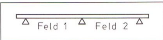
Abb. 7 Träger auf mehreren Stützen (Durchlaufträger).
