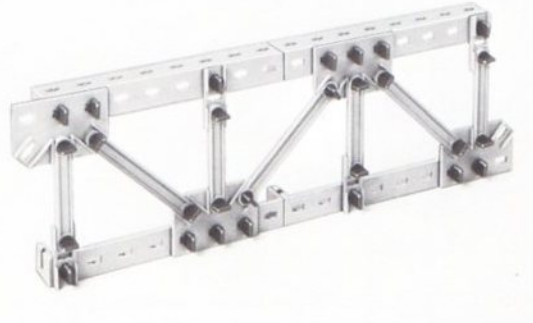
Abb. 166 Die über die Gurte hinausragenden Doppelknotenplatten ermöglichen eine sachlich korrekte Befestigung der Streben: Der Schnittpunkt der Stabachsen liegt im mittleren Riegelloch der Knotenplatten im Zentrum der Gurte.
