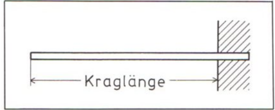
Abb. 8 Einseitig eingespannter Träger (Einspannträger), z. B. Balkon-Kragplatte.
