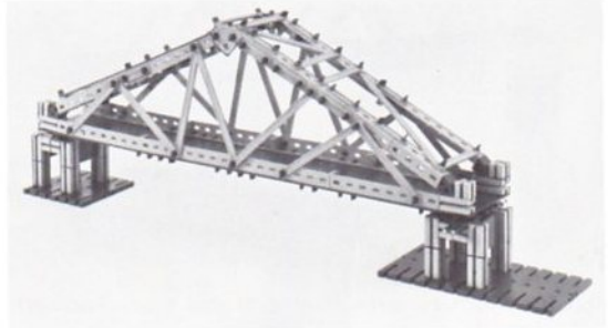
Abb. 210 Modell eines „ausgefachten Hängewerks“, bei dem die aufwendige Ausfachung auf der Vorderseite noch unsymmetrisch angeordnet ist.
