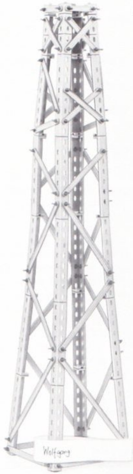
Abb. 328 Das Modell von Wolfgang ist durchaus als gut zu bezeichnen, wenngleich einige Schwächen genannt werden müssen: Fehlende und ungleich eingesetzte Streben im oberen Teilstück. Auch hier muß dies nicht unbedingt verbessert werden, wenn das Wissen um diese Schwächen vorhanden ist.
