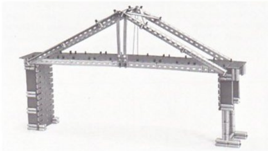
Abb. 82 „Bauteiltypisches“ Modell einer Hängewerkbrücke. Anstelle der aus U-Profil bestehenden Hängesäulen von Abb. 81 sind hier der Zugbeanspruchung entsprechende Bauteile eingesetzt. Auf der Vorderseite sind mittels Prüfriegeln (weiße flexible Riegel) Streben 106, auf der hinteren Seite gar nur Schnüre benutzt. Die aus knickbelastbaren Winkelträgern gefertigten Streben sind oben durch einen Kreuzverband zusammengeführt. Dieser „Windverband“ ist gleichzeitig ein Knickverband, der die mit Strebendruck belasteten Firstpunkte am Ausknicken hindern soll.
