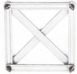
Abb. 152 Eine Strebe „zuviel“ (siehe Abb. 150) erbringt zwar anscheinend mehr Starrheit; sie ist jedoch im Sinne der Stabilität nur dann nötig, wenn sie zur Aufnahme besonderer Druck- oder Zugkräfte erforderlich wird.
